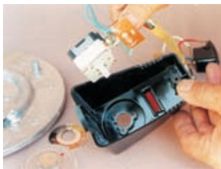
● در شکل ۲۰-۴، لامپ خبر و ترمینال دیده می‌شود. مجموعه‌ی موتور و تایمر دو قسمت به هم چسبیده هستند. با گرداندن تایمر کلید روشن خواهد شد و تایمر وارد مدار می‌شود.
