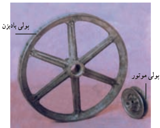
شکل ۸-۱۱ - پولی‌های موتور و فن
