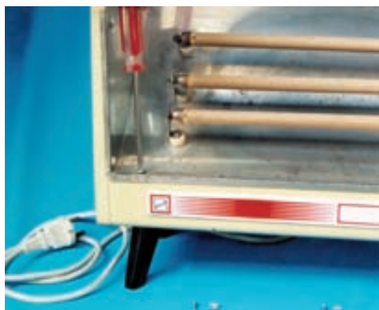
برای تعمیر و یا تعویض المنت باید چهار عدد پیچ چهارسوی متصل به بدنه را باز کنید (شکل ۲۴-۲).
