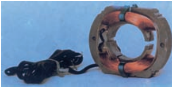
شکل ۸-۱۴ استاتور و هسته پمپ آب
