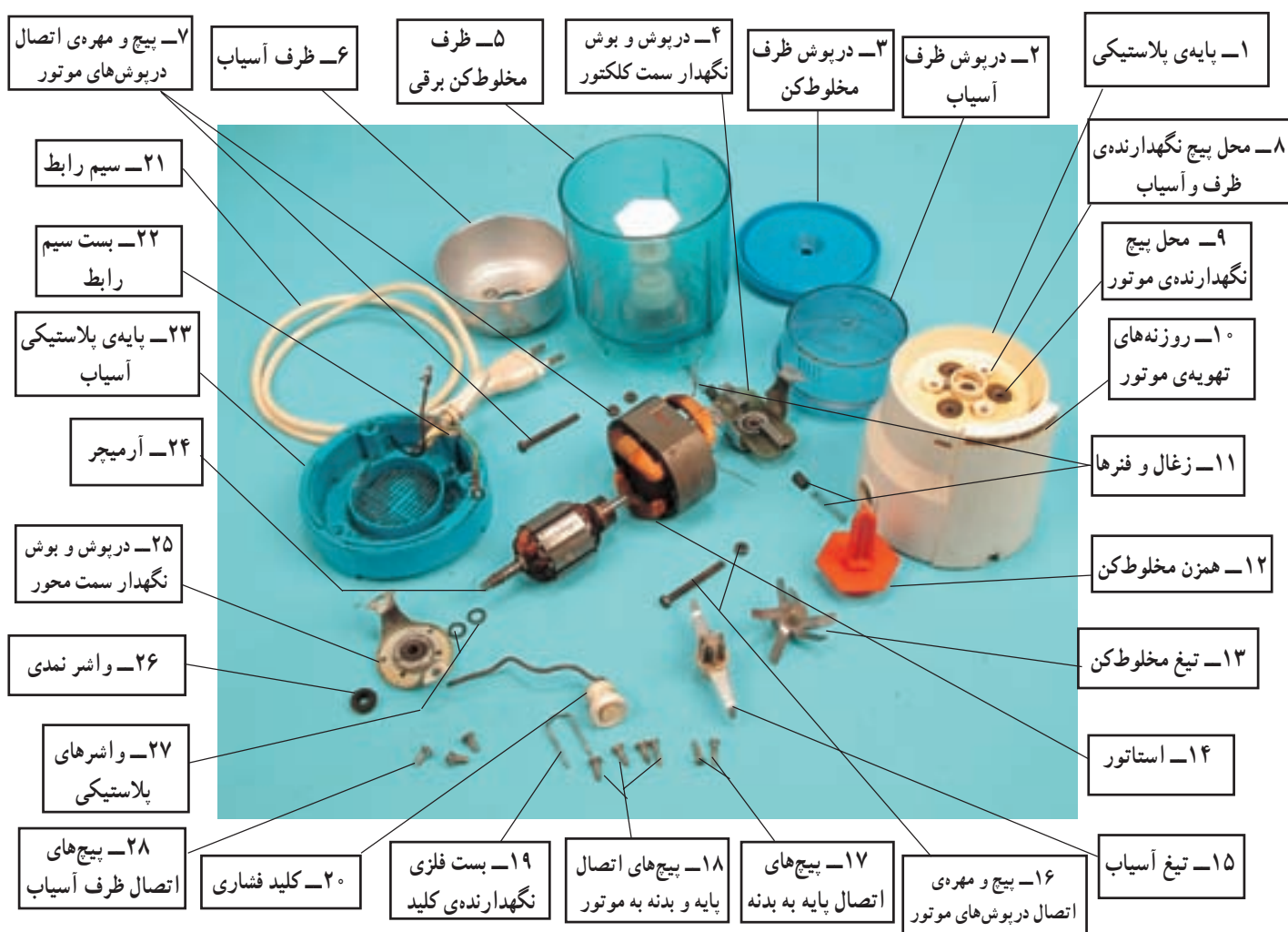
شکل ۴-۳۲- اجزای ساختمانی یک نمونه مخلوط‌کن برقی
