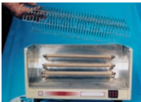
● طبق شکل ۲۳-۲ حفاظ را از داخل لولای خود خارج کنید. فاصله‌ی بین میله‌های حفاظ باید استاندارد و به گونه‌ای باشد که دست به المنت‌ها نرسد.
